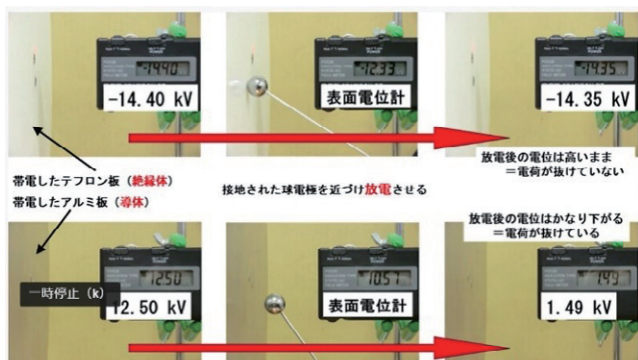
写真4 絶縁体（上段）と導体（下段）の放電前後の帯電電位の変化
